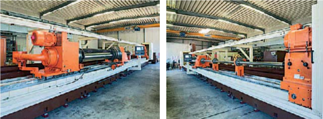
Рис. 3.1., 3.2. Крупногабаритный станок глубокого сверления (система ВТА).
