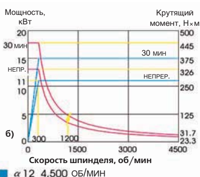
Рис. 5. а - ременной привод; б - редукторный привод; в - редукторный привод.
