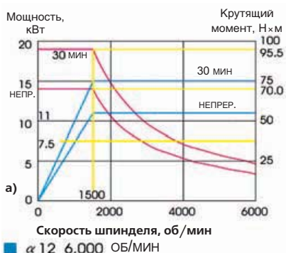
Рис. 5. а - ременной привод; б - редукторный привод; в - редукторный привод.
