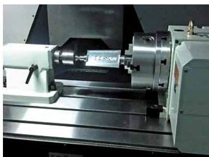
Обработка детали «Лопатка» на станке DNM500 с поворотным столом
