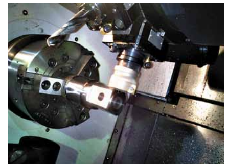
↑ Процесс обработки детали «Валик» на станке DOOSAN PUMA 2100 SY
