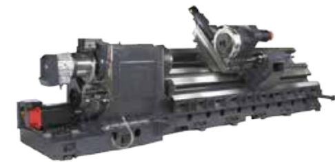
Цельнолитая наклонная станина под углом 45°, с корбачатыми направляющими скольжения.
