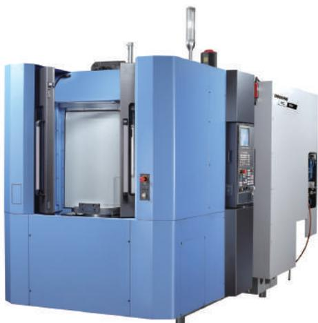
Высокопроизводительные горизонтальные обрабатывающие центры отличаются простотой в управлении и компактным дизайном. Максимальная скорость шпинделя – **8000/12000 об/мин**, скорость быстрых перемещений – **40 м/мин**. Конус шпинделя **ISO № 40**. Дополнительно оснащаются магазинами для смены инструмента на **60/80/120/170/262** позиции.
